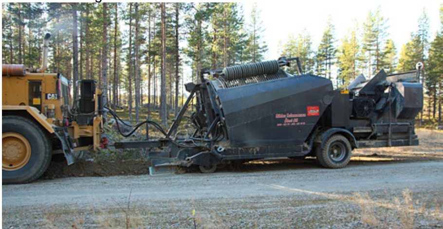
Grusåtervinning med Mählermetoden hos Sveaskog i Västerbotten. Foto Mats Hannerz.
