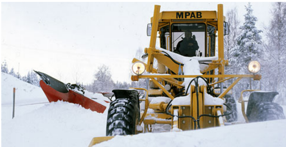
Dikningen görs smidigast med en vallvinge monterad på en väghyvel. Teckning Anna Marconi.
