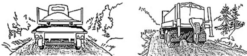
Saltning med sandspridare (till vänster) och tallriksspridare (till höger). Teckning Ulla Carne.
