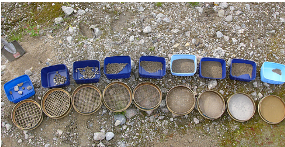
Ett bra vägmateriale ska innehålla korn i alla storleksklasser, och följa idealgruskurvan så nära som möjligt. Med siktnings kan man se hur mycket material som finns i olika kornstorleksklasser. Foto Fredrik Staland.
