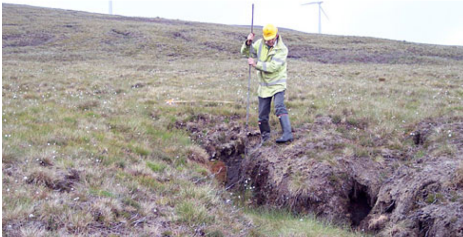
Sondning på torvmark för ny väglinje. Bilden är från Skottland. Foto R Main, Forestry Commission.
