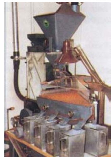
Gravitationsskakbord för frörensning och fraktionering. Foto: Kjell Andersson
