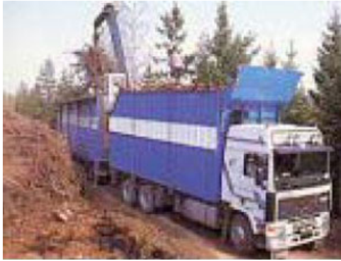
3. Lösgröten lastas på grotbil för transport till terminal eller slutkund.
