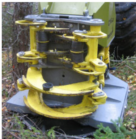
Bracke C16, ett fällhuvud med en sågkedja monterad på en cirkulär klinga. Foto: Mia Iwarsson Wide.
