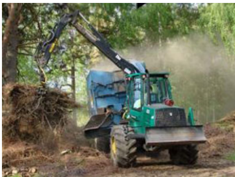
3. Flisning görs vid avlägg med mobil flisare, huggbil eller hugglink.
