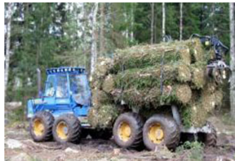
2. Grotbuntarna skotas till avlägg med skotare. De kan nu hanteras nästan som rundvirke.
