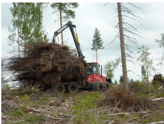
En risskotare i arbete. Lastutrymmet är normalt bredare än på en rundvirkeskotare. Foto: Tomas Johannesson
