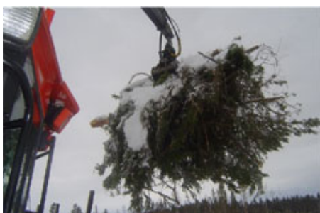
Ett väl utfört arbete av skördaren underlättar för skotningen. Det samlade knippet till vänster har mindre volym och ger en effektivare last. Undvik de spretiga knippena till höger. Foto: Tomas Johannesson
