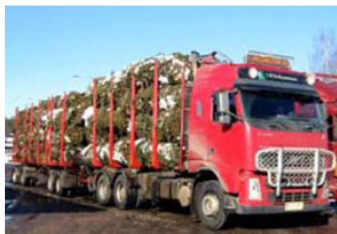
4. Grotbuntarna transporteras med buntbil till terminal eller värmeverk.
