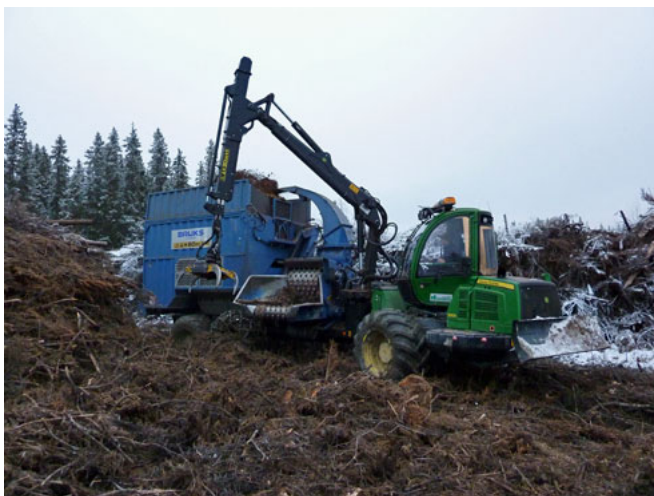
Flistugg på skotare med flisbehållare. Foto: Tomas Johannesson
