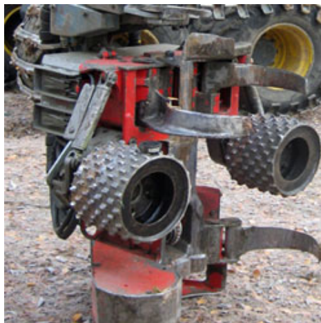
Log Max 4000B, ett fälldon med svärd. Foto: Mia Iwarsson Wide.
