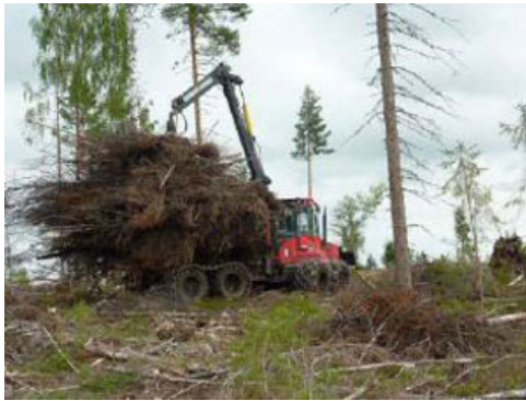
1. Efter att grothögarna torkat en säsong transporteras groten ut av en grotskotare till avlägg.
