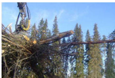
Ett väl utfört arbete av skördaren underlättar för skotningen. Det samlade knippet till vänster har mindre volym och ger en effektivare last. Undvik de spretiga knippena till höger. Foto: Tomas Johannesson
