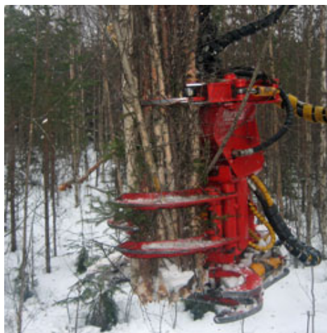
Naarva Gripen, ett fälldon med gilotin för skördare, kombimaskiner och grävmaskiner. Foto: Mia Iwarsson Wide
