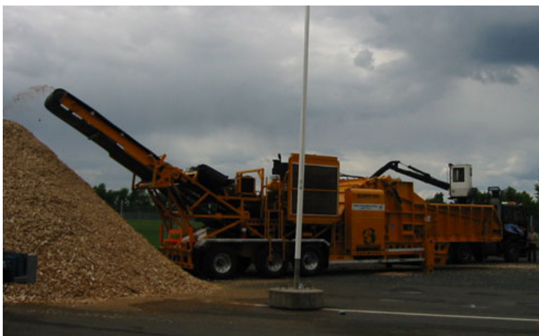
Större flishugg vid terminal. CBI Magnum Force med huggtrumma, presenterad vid Elmia. Foto: Rolf Björheden.
