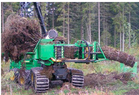
Lösgroten kan buntas till grotstockar som kan hanteras som rundved. Foto: Gustaf Egnell.
