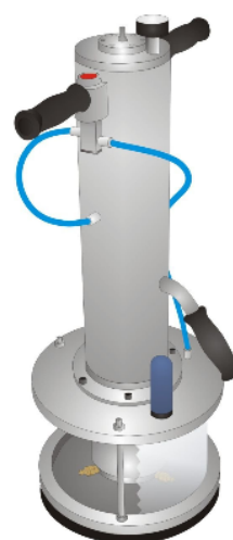
Figur 3. Laborietrustning för generering och uppsamling av damm
