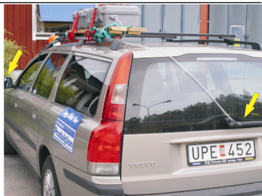
Figur 1. Montage av DustTrak-utrustningarna på testfordon. Dammsugerna är markerade med pilar.
